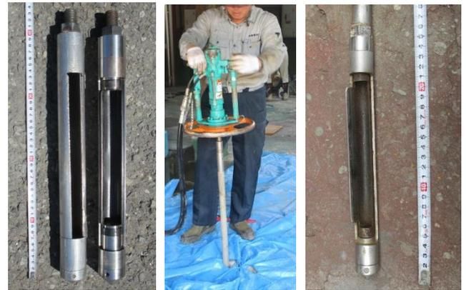
(1)SRS 新開閉式 SP (2)手動 VibroSP (3) SWS 開閉式 SP
