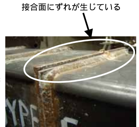
図-7 終局状態 (MS-1の引張接合面)
