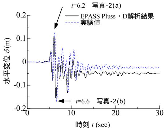
図-6 水平変位の時刻歴応答(DH-3)
