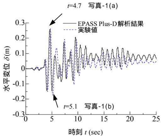
図-7 水平変位の時刻歴応答(DH-1)
