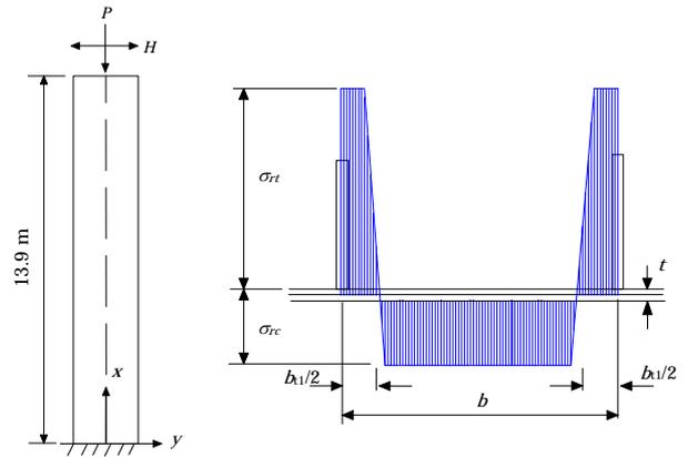
図-3 側面図 図-4 導入残留応力分布図
